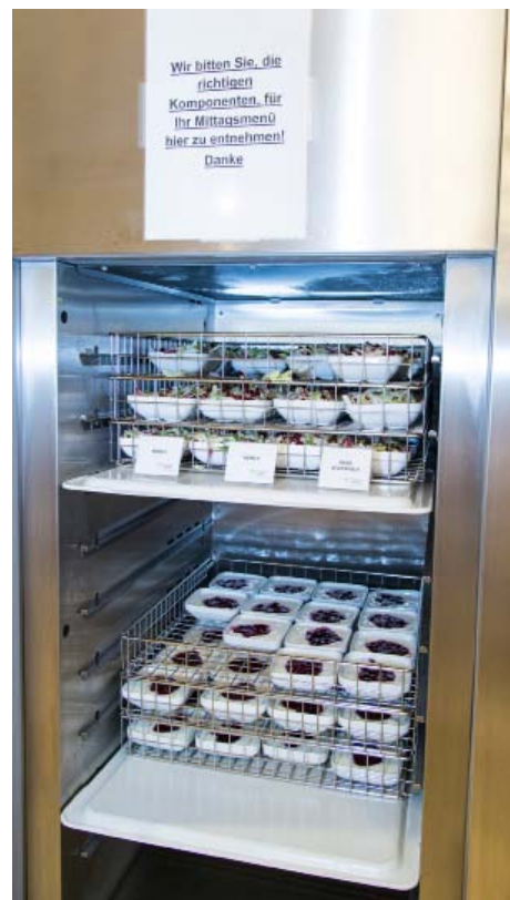
Buffetkühlschrank: Ein Kälteschleier schützt empfindliche Speisen wie portionierte Salate oder Puddings und Cremes.
